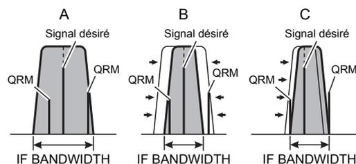
Pour une réduction efficace du brouillage, les fonctions WIDTH et SHIFT sont les outils principaux à utiliser, après avoir réduit la largeur de bande (WIDTH) et/ou réglé le centre de la bande passante (SHIFT). Le réglage Contour peut ensuite produire des avantages supplémentaires d'amélioration des signaux sur le reste de la bande passante nette. De plus, l'utilisation du filtre NOTCH IF (décrit plus loin) en même temps que ces systèmes de filtre, fournit des avantages considérables.
