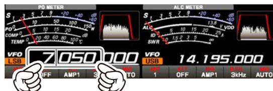
Touchez la zone "MHz" ou "kHz" de l'afficheur de fréquence pour confirmer. Si aucune opération n'est effectuée dans un délai de 3 secondes, la fréquence devient fixe.
