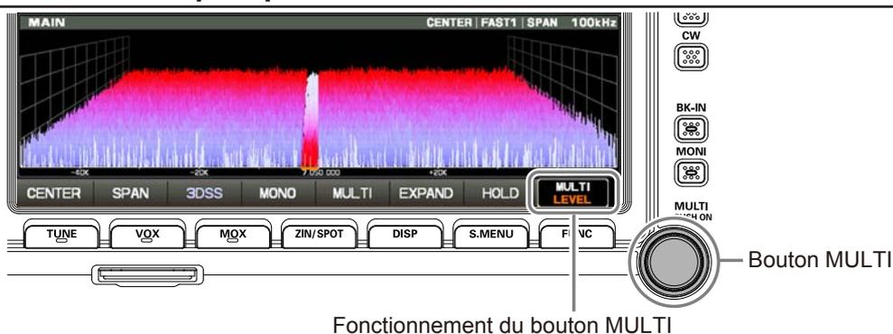
Les réglages et opérations suivants peuvent être effectués avec le bouton [MULTI].
