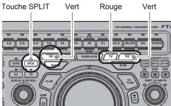
Pendant le fonctionnement en mode Split, le registre de la bande PRINCIPALE sera utilisé pour la réception tandis que le registre de la SOUS-bande sera utilisé pour l'émission. En appuyant à nouveau sur la touche [SPLIT], le mode Split sera annulé.
