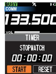
5. Um die Zählung zu stoppen, **"STOP"** auswählen, und die **[ENT]**-Taste drücken. Um die Zählung fortzusetzen, **"START"** auswählen, geändert von **"STOP"**, und die **[ENT]**-Taste drücken.
