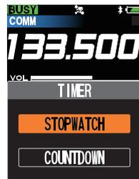
4. Um das Zählen zu beginnen, **"START"** auf dem Display durch Drücken der Taste **[▲]** oder **[▼]** auswählen, und dann die **[ENT]**-Taste drücken. Die angezeigte Zeit erhöht sich und **"START"** wechselt auf **"STOP"**. Das Symbol "G" wird während des Zählens auf dem Display oben rechts angezeigt.
