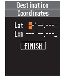
Um einen Tippfehler zu korrigieren, die Taste [▲] oder [▼] drücken, um den Cursor auf die zu ändernde Ziffer zu setzen, und dann Schritt 3 wiederholen.
