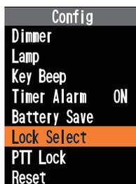
4. Eine der folgenden Sperrkonfigurationen durch Drücken der Taste [▲] oder [▼] auswählen, und dann die [ENT]-Taste drücken.
