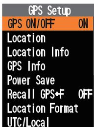
4. **“ON”** auf dem Display durch Drücken der Taste **[▲]** oder **[▼]** auswählen, und dann die **[ENT]**-Taste drücken. Das GPS-Modul wird eingeschaltet und die Anzeige kehrt zum Menü **GPS SETUP** zurück.
