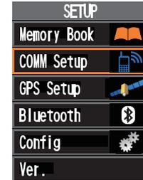
4. Die Option, deren Einstellungen angezeigt und/oder geändert werden sollen, durch Drücken der Taste **[▲]** oder **[▼]** auswählen, und dann die **[ENT]**-Taste drücken.
