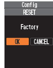
Die Initialisierung startet, und dann wird **“Complete!”** (Beendet) angezeigt, nachdem das Funkgerät zur Werkseinstellung zurückgekehrt ist.
