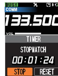
6. Zum Löschen der Zählung **"RESET"** auf dem Display durch Drücken von **[▲]** oder **[▼]** auswählen, und dann die **[ENT]**-Taste drücken.
