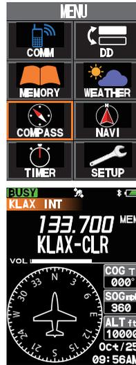
Der Kompass mit der Kursrichtung oben, COG (Course over Ground = Weg über Grund), SOG (Speed over Ground = Geschwindigkeit über Grund), Höhe und das Datum werden angezeigt.
