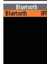
5. "ON" auf dem Display durch Drücken der Taste [▲] oder [▼] auswählen, und dann die [ENT]-Taste drücken.
