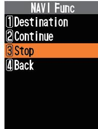
3. Ein Bestätigungsdisplay wird angezeigt. Um die Navigation zu beenden, die **[ENT]**-Taste drücken. Die Navigation anhalten und das Kompassdisplay anzeigen.
