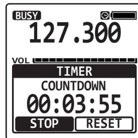
6. Per arrestare il conteggio, selezionare "STOP" e premere il tasto [ENT]. Per riprendere il conteggio, selezionare l'indicazione "START" che ha sostituito "STOP" e premere nuovamente il tasto [ENT].
