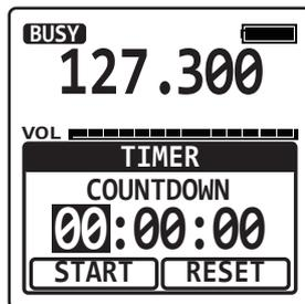
5. Per iniziare il conteggio, selezionare "START" sullo schermo premendo il tasto [◀] o [▶], quindi premere il tasto [ENT]. Il tempo visualizzato diminuisce e "START" viene sostituito da "STOP". L'icona "🕒" viene visualizzata sulla parte superiore destra del display durante il conteggio.
