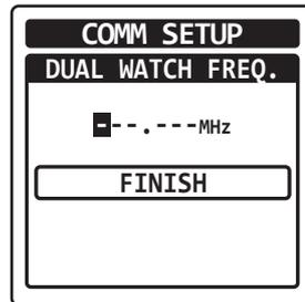
6. "FINISH" auf dem Display durch Drücken der Taste [◀] oder [▶] auswählen, und dann die [ENT]-Taste drücken.
