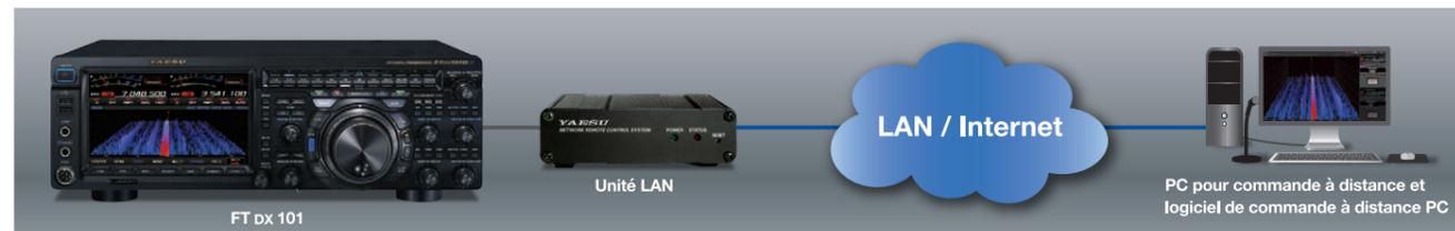
En communiquant l'émission/réception vocale, le scope RF, le scope AF et les commandes CAT à l'émetteur-récepteur, il est facile de configurer l'affichage du scope du moniteur de l'état de la bande, les différents paramètres du filtre, les fonctions de réduction du brouillage, etc. depuis le PC. Il est possible de communiquer confortablement depuis n'importe quel lieu éloigné.
